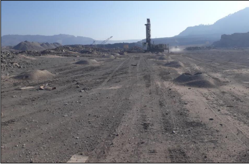
Şekil 1. BYL panoda patlatma delikleri ve Ingersoll-Rand delici.
