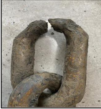
Şekil 7. AFC konveyör zincirinin kopan baklasını gösterir görsel (Erel vd., yayımlanmamış)
