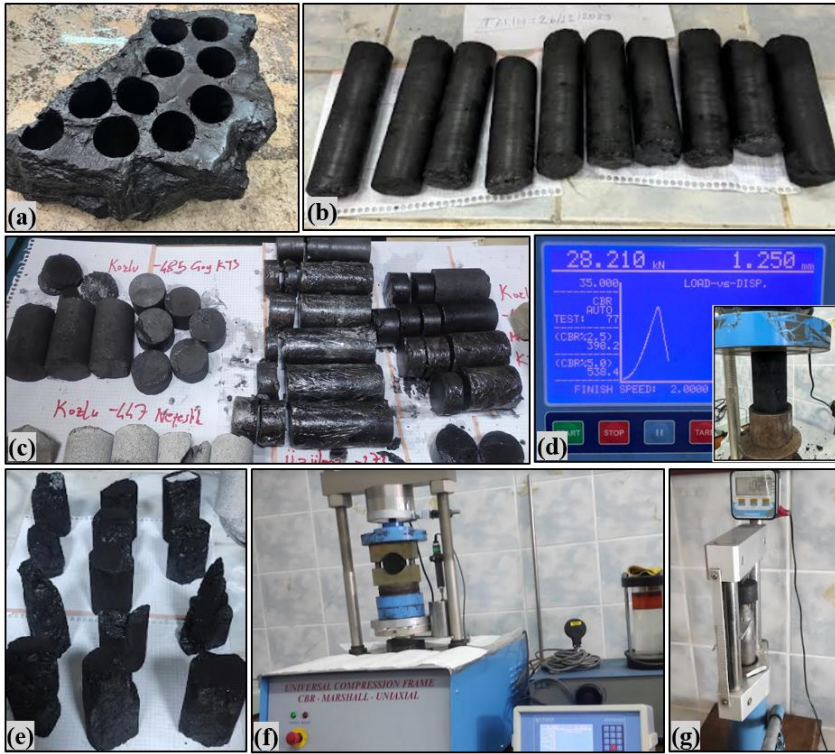
Şekil 2. Deneysel çalışmalardan görüntüler; kömür bloğu (a), bir bloktan alınan örnekler (b), karotların deneye hazırlanması (c), dayanım (UCS) deneyi (d), UCS sonrası örnekler (e), BTS deneyi (f), PLI deneyi (g).
