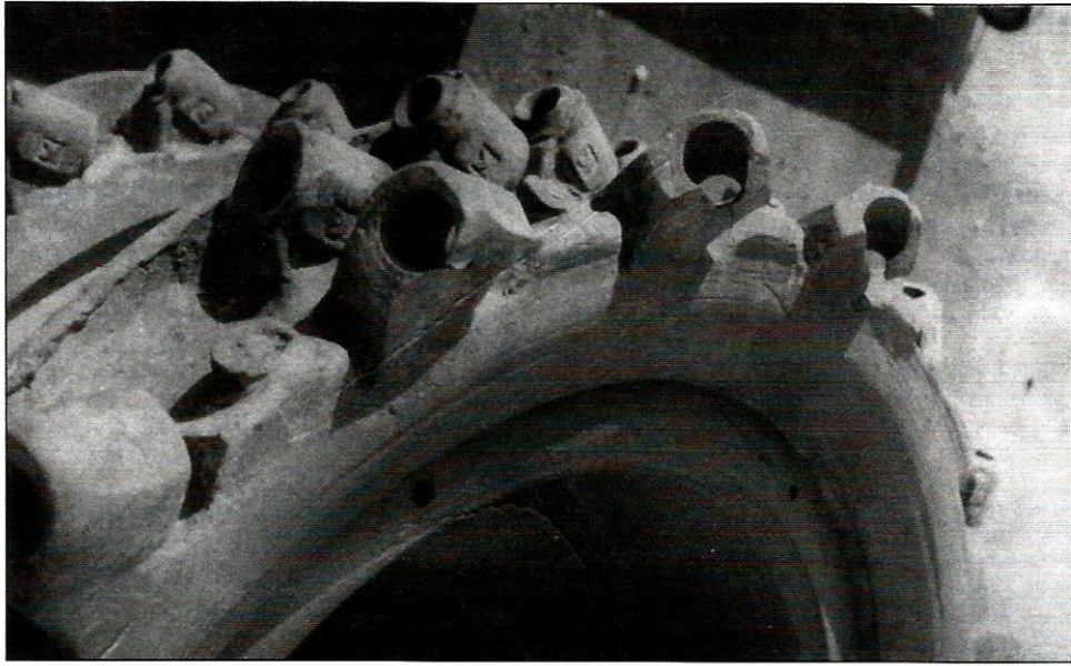
Şekil 6. Kesici tamburun alın plakasında oluşan keski tutucu ve tambur aşınması.
